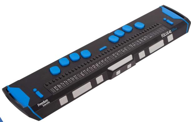
Il display Braille Focus Blue, con 40 celle Braille, ha un telaio composto da alluminio e acciaio. Sono stati aggiunti dei bumper per attutire i colpi e le celle Braille sono state fisicamente isolate.
