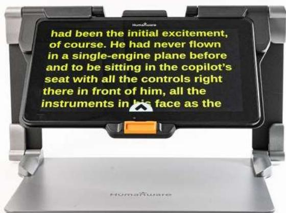
Connect 12 è un videoingranditore portatile con monitor da 12.2" touch screen Full HD che permette di ingrandire testi e oggetti fino a 40x e di modificare la visualizzazione di scritte e sfondo tramite l'aumento dei contrasti e il cambiamento dei colori.
