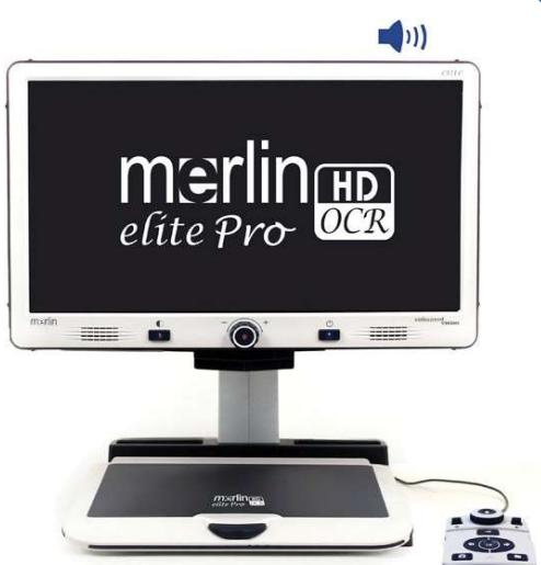
Merlin Elite Pro è un videoingranditore da tavolo dotato di telecamera Full HD, di un software OCR (riconoscimento dei caratteri) e di un Text-to-Speech (TTS - vocalizzazione del testo stampato). La telecamera ad alta definizione di Merlin Elite Pro mostra immagini chiare con colori e contrasti brillanti. Con la pressione di un pulsante, Merlin Elite Pro permette di passare in tempo reale dalla modalità immagine alla modalità OCR per permettere la lettura dei testi tramite TTS.
