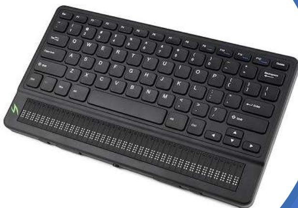
Mantis Q40 è un dispositivo braille che, grazie alla batteria e alla tastiera integrate, può essere utilizzato anche senza essere collegamento ad un PC, ha un editor di testi integrato, una calcolatrice e la gestione dei file per la copia, lo spostamento e l'eliminazione di file di testo nei formati più comuni. E' inoltre possibile usare chiavette USB o schede SD.
